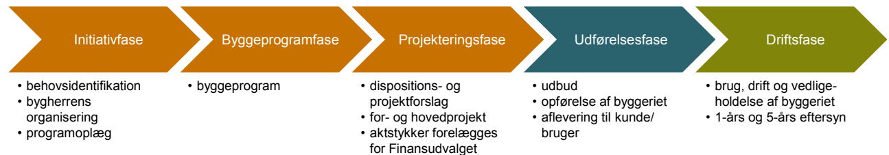
Figur 1. Faser i et byggeprojekt
