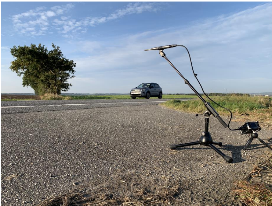
Figur 1. Optagelse af vejstøj med en bredbånds målemikrofon Earthworks M30 HIGH DEFINITION Microphone og en MultiTrack Field Recorder ZOOM F6 (ZOOM), opsat til 24bit linear mode, sample rate 192kHz.
