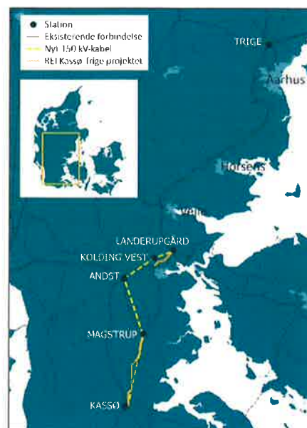
Figur 6 Planlagt tracé for 150 kV i Syddjylland.
