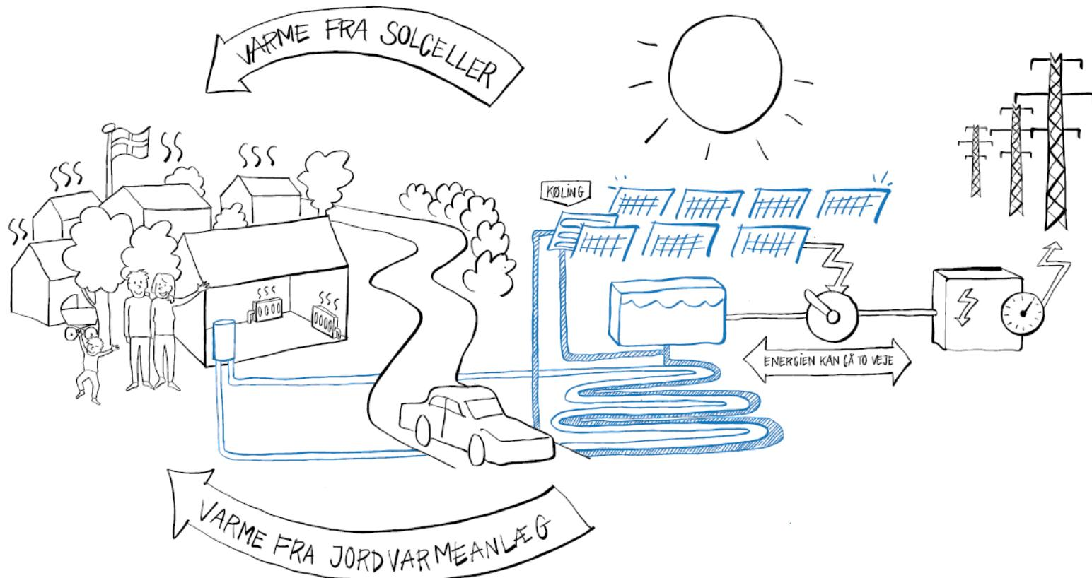
1. Nedkøling af solceller vil forøge produktion fra solceller og opvarme termonet og derved reducere husstandes energiforbrug i varmepumper
