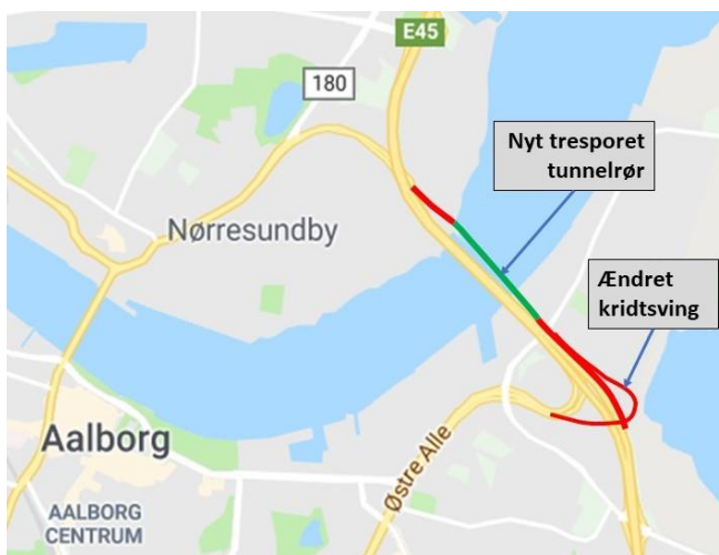
Figur 3 - Ekstra tunnelrør og Kridtsvinget
