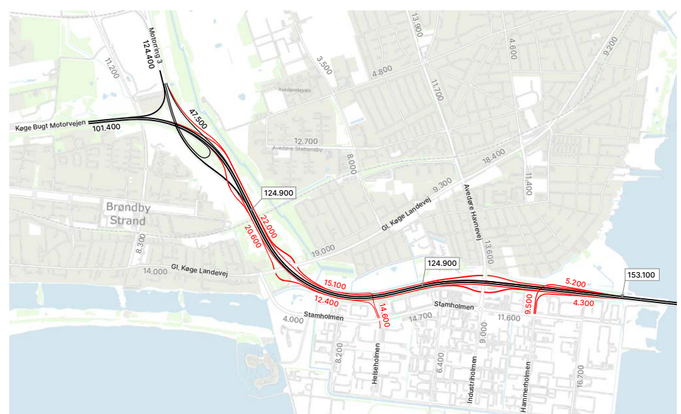
Figur 10 Fordelingen af hverdagsdøgntrafik mellem Amagermotorvejens fordelingsveje (røde) og motorvejsstrækning (sort) i 2030
