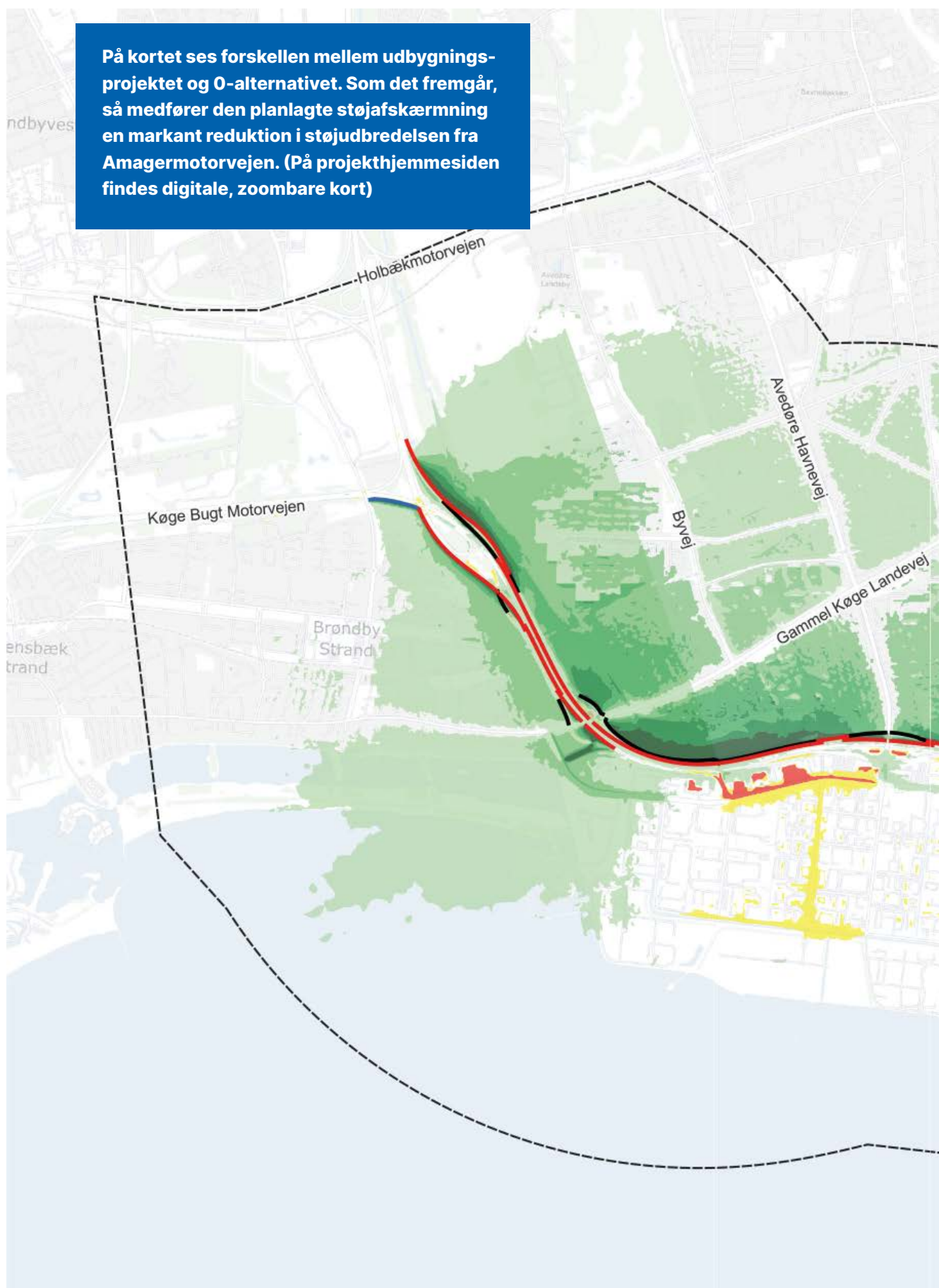
Figur 16 Forskelskort der viser dæmpningen af støjen i udbygningsprojektet i forhold til 0-alternativet. (På projekthjemmesiden findes digitale, zoombare kort)
