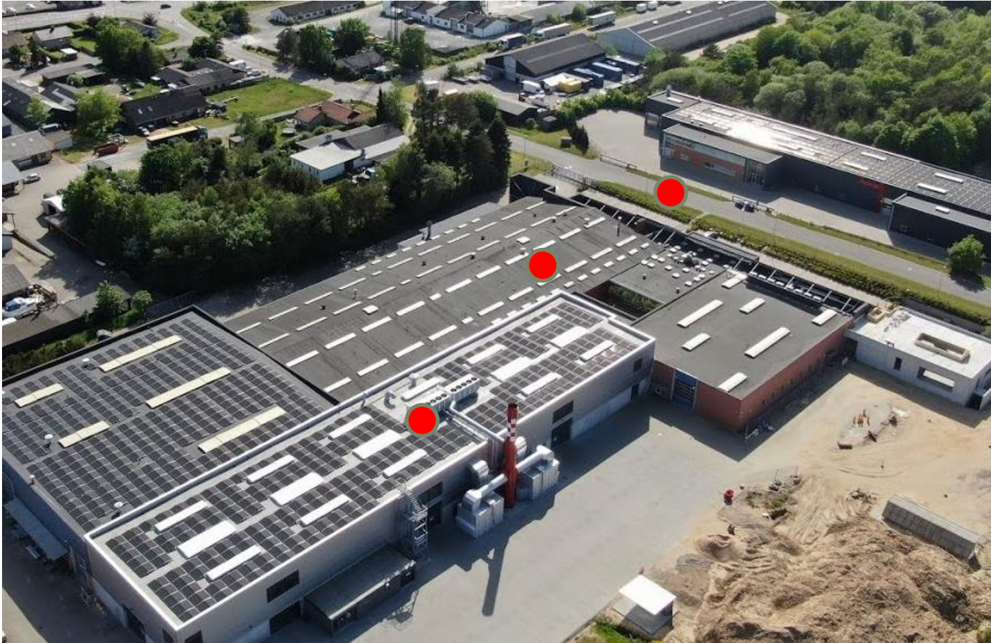
Billede: Haarup Maskinfabrik. 4500m 2 solpaneler med en årlig produktion på ca. 1.050.000 kWh.
