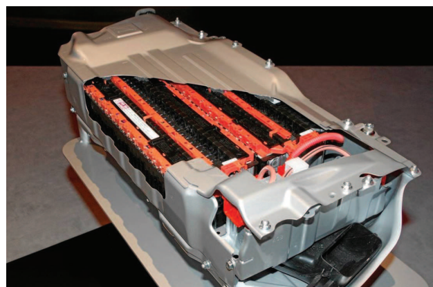
Batteri opbygget i rækker. Tragten til luftkølingen af batteriet fremgår tydeligt nederst til højre.
