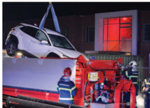
Nedsænkning af elbil i Beredskab Øst 'elbilscontainer'
