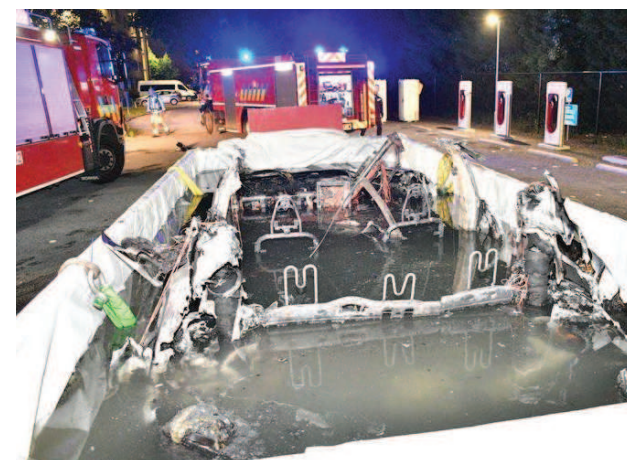
Køling af elbils batteri, ved fyldning af container med vand
