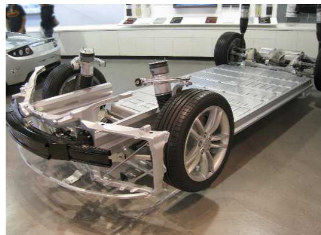
Batteriramme, der udgør hele undervognen på en Tesla Model S
