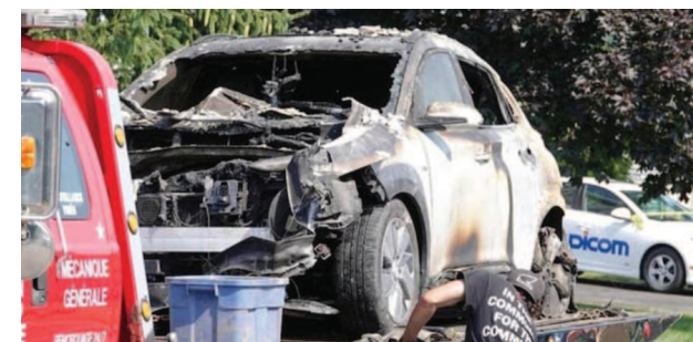
Borttransport af elbil på fejeblad – fastspændt og i vandret position
