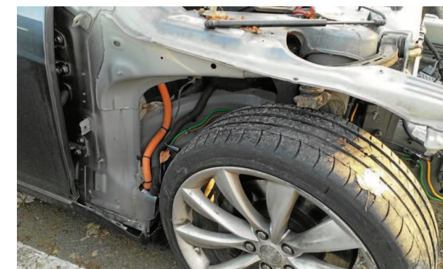
Orange ledninger med høj spænding ved A-stolpe ved højre forhjul
