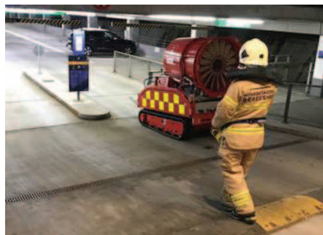
Anvendelse af LUF 60, til henholdsvis ventilering og bugsering af elbil fra P-hus eller P-kælder
