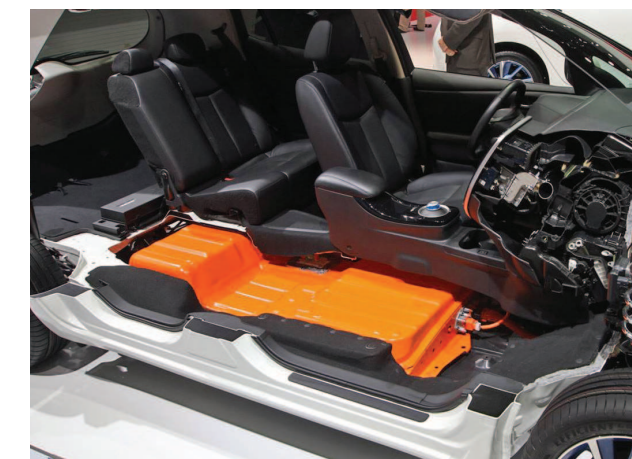
Batterier integreret under sæder i kabinen.
