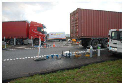
Illustration 2: Billede af afprøvningen af stationær remote sensing i Danmark. Kilde: (Ole Hertel, Report number 387 year: 2020).
