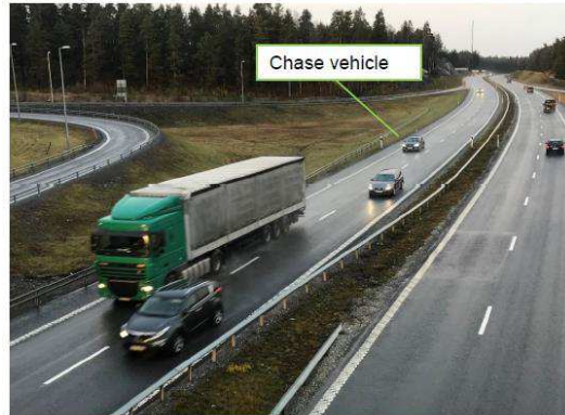
Illustration 4: Plume chasing bilen ligger efter en lastbil på motorvejen. Det ses hvordan plume chasing bilen måler emissionen af NO x på den foranliggende lastbil. Afstanden mellem plume chasing bilen og det forankørende køretøj er ca. 50 m. Kilde: (Janssen Jens - AVL, 2020).
