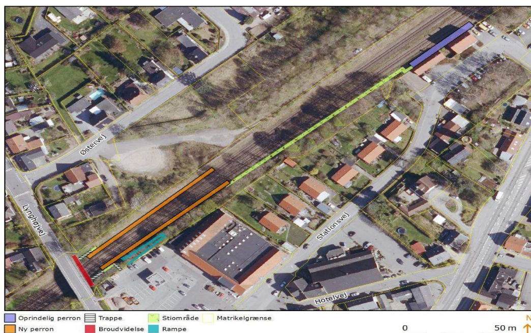
Principskitse af perroner, trapper, rampe og stiforbindelse til Stationsvej.
