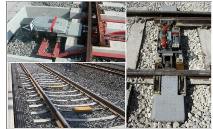
Figur 2.5. Elektrohydrauliske sporskiftedrev fra henholdsvis Thales & Strukton og Alstom samt en passiv ETCS balise (nederst TV), som også anvendes på S-banens CBTC-system.
