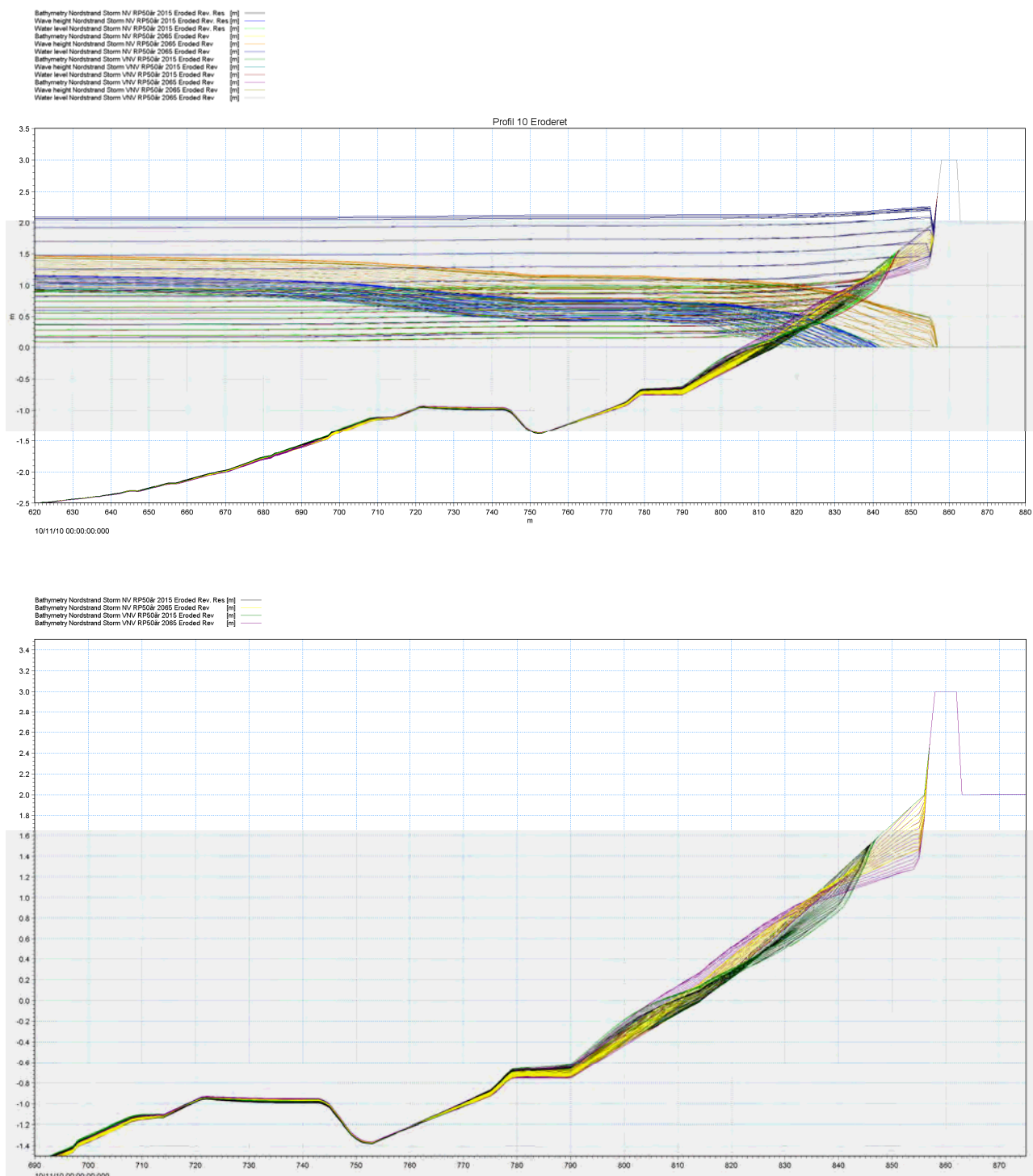
Figur 5-29 Nordstrand Profil 10, udvikling af eroderet sandfodringsprofil som følge af dimensionsgivende stormhændelse, samt bølge og vandstandsforhold
