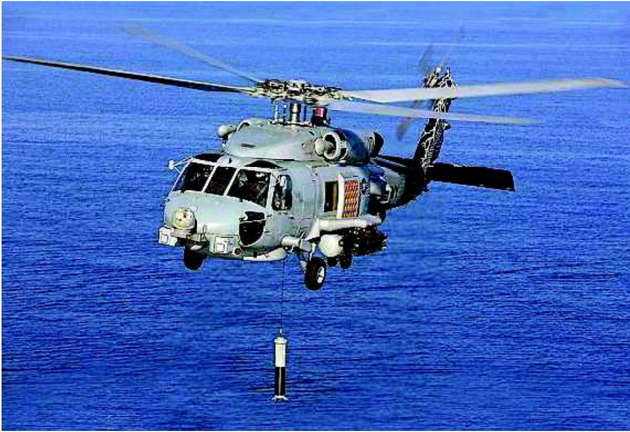
Amerikansk SEAHOAWK-helikopter med dyppesonar til anti-ubådsoperationer.
