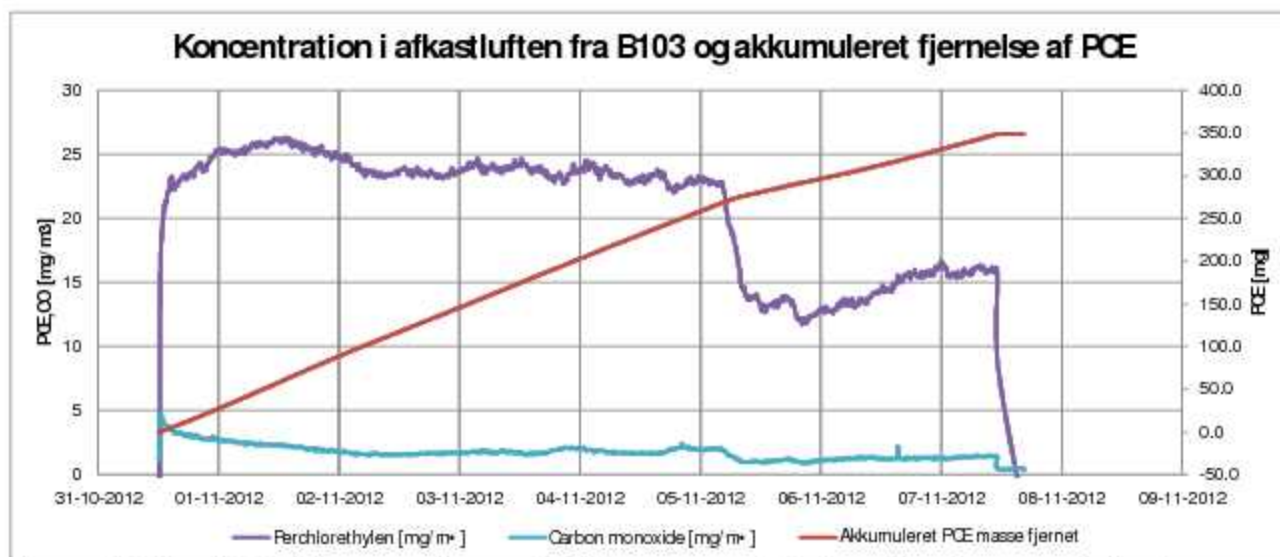
Figur 2. Tidlig udvikling i koncentrationen af PCE og traceren CO i afkastluften fra pumpeboring B103 samt akkumuleret fjernelse af PCE under forsøget.
