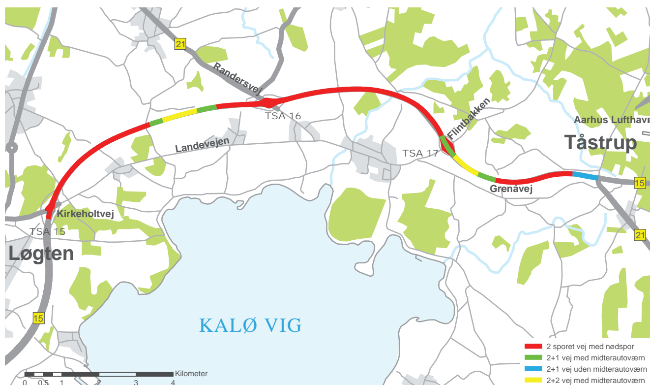
FIGUR 2.1 Den aktuelle strækning af Rute 15 med angivelse af 2+1 og 2+2 strækninger.
