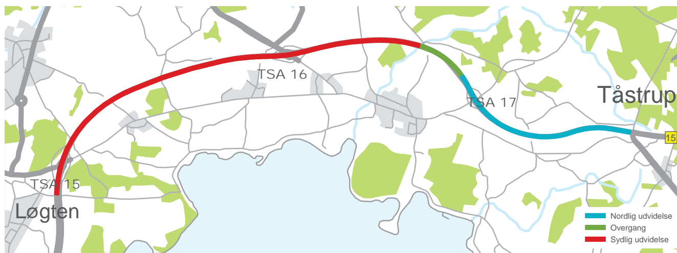
FIGUR 4.2 Forslag til asymmetrisk udbygning til motorvej
