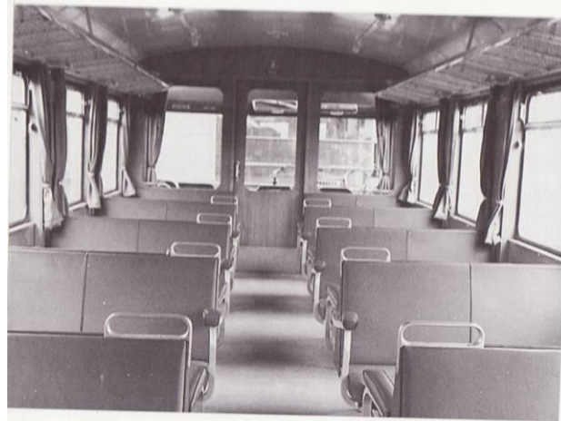
Innenraum des ETA 150 115 von MAN, Abteil 2. Klasse (oben) und Abteil 1. Klasse (unten) mit Sitzteilung 2 + 1.
