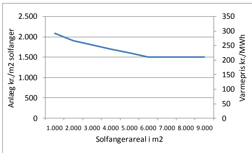
Figur 2 Anlægsomkostninger som funktion af solvarmeanlæggets størrelse samt tilhørende solvarmepris
