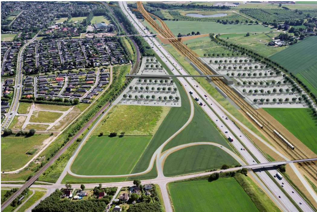
Køge Nord Station (th.) placeres tæt på motorvejen og med gangforbindelse til Køge Bugt S-banen (tv.). Her vist i parkér-og-rejs udgaven med motorvejsramper og med et eksempel på 1500 parkeringspladser.
