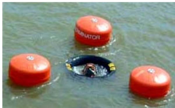
TERMINATOR skimmer til lettere olietyper, der er i stand til af sig selv at flyde til sugeaggregatet på pumpen.
