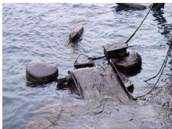
Bælteskimmer kassette til TERMINATOR. Beregnet på opsugning af tung olie med stor viskositet. En sådan olie kan ikke pumpes op med en TERMINATOR skimmer alene. Kan yderligere monteres med "High Water injection Flange", som tilsætter koldt eller varmt vand således, at selv tjæreagtig olie kan pumpes om bord på modtagerfartøjet uden at sidde fast i afgangsslangen.
