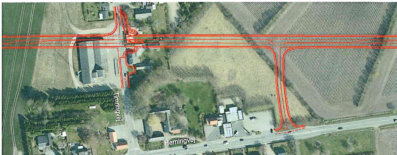
Figur 1 Skitse af ny omfartsvej og kryds nord om Vorgod-Barde - ca 13.000 bilister/døgn. Bemærk helleanlæg, hvor bløde trafikanter skal passere hovedvejen
