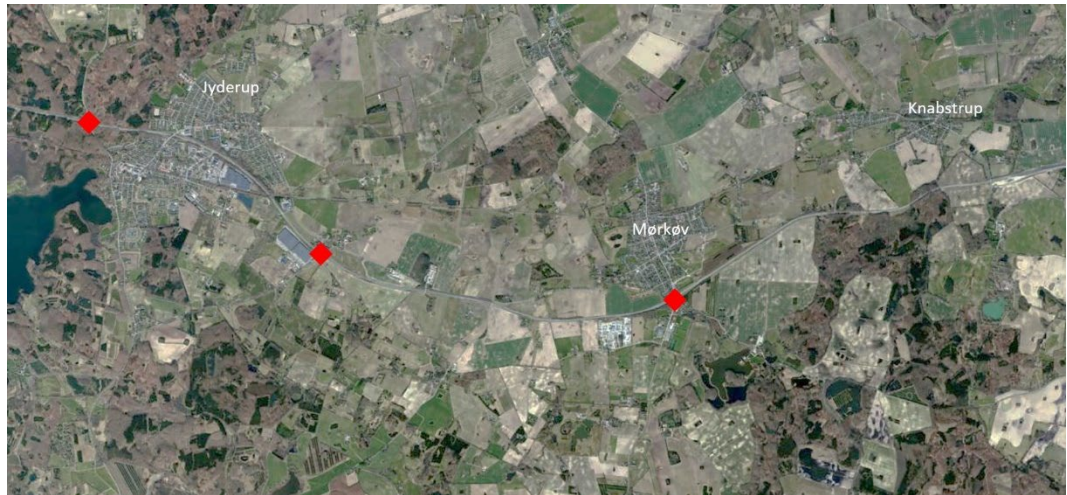
Figur 3. Planlagte tilslutningsanlæg til Kalundborgmotorvejen i Holbæk Kommune.
