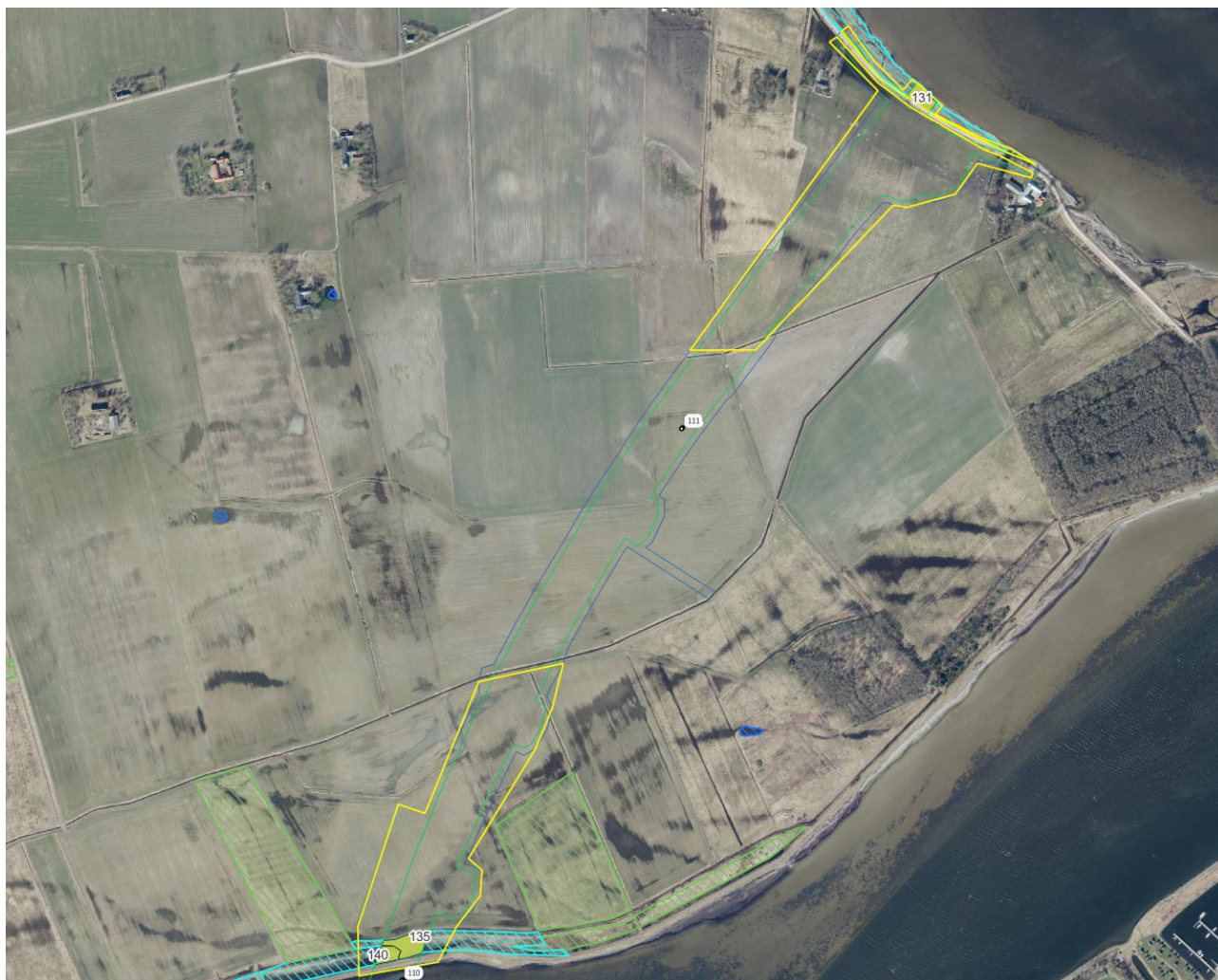
Figur 2 Anlægsfeltet indhegnes med paddehegn (GUL) i de områder, hvor der er risiko for at der er padder, herunder strandtudse. Figuren viser områderne på Egholm. Hegningerne indeles i praktiske enheder i fht veje og vandløb. Hegn tilpasses de erstatningsvandhuller, der graves forinden.
