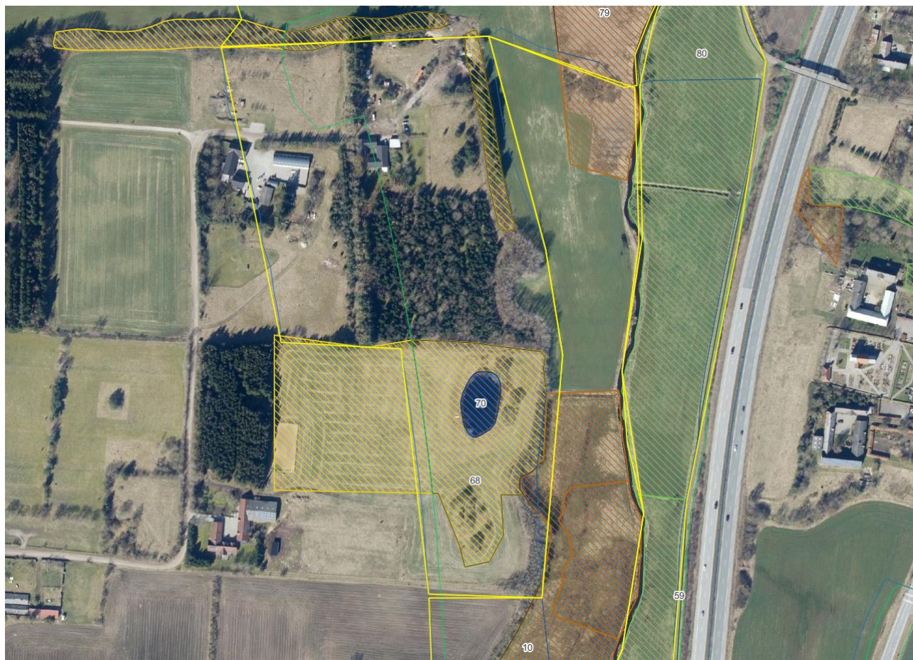
Figur 6 Anlægsfeltet indhegnes med paddehegn (GUL) i de områder, hvor der er risiko for at der er padder, herunder strandtudse. Figuren viser området omkring vandhul 70. Hegningerne indeles i praktiske enheder i fht. veje og vandløb. Hegn tilpasses de erstatningsvandhuller, der graves forinden.
