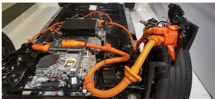
Elektrisk installation i elbil 400-900 Volt DC
