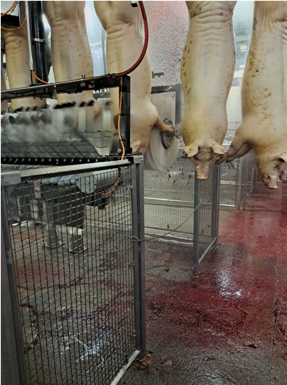
Grisene bliver kørt via conveyer ind i skrabemaskine.
