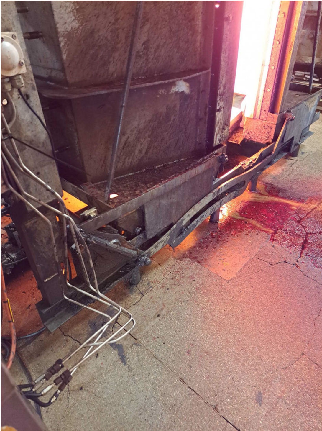
Svideovnen åbnes automatisk, når grisene skal ind i ovenen.
