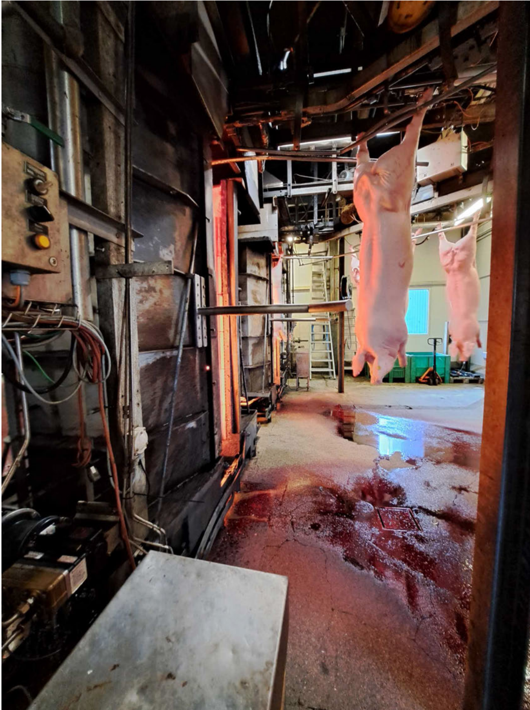
Grisene bliver transporteret på conveyerbane direkte ind i svideovn. Ingen afskærmning eller anden adgangssikring til oven.
