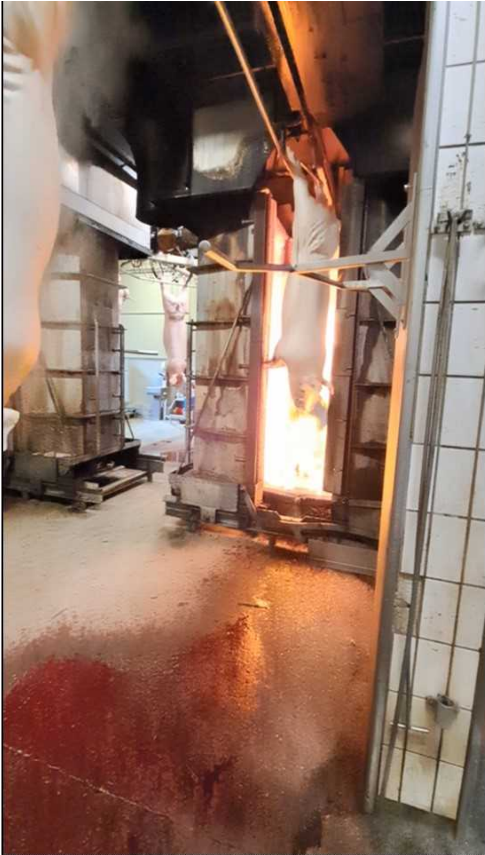
Svideovnen åbner automatisk, når grisen skal ud af ovnen, hvorefter den lukker igen.
