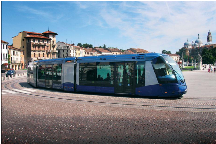
Tram sur Pneufs, Alstom, Frankrig /Spovogn på gummihjul. Elektrisk med elskinne.
