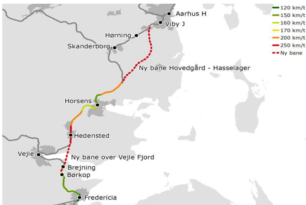
Fig. 2. De nye baner ved Vejle fjord og mellem Hovedgaard-Hasselager, som hastighedsopgraderingerne er planlagt ud fra.
