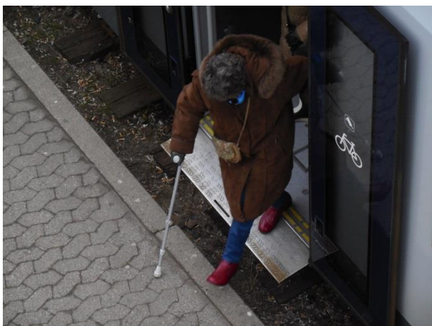
Passager stiger ud af tog, hvor der er afstand mellem togtrin og perron
