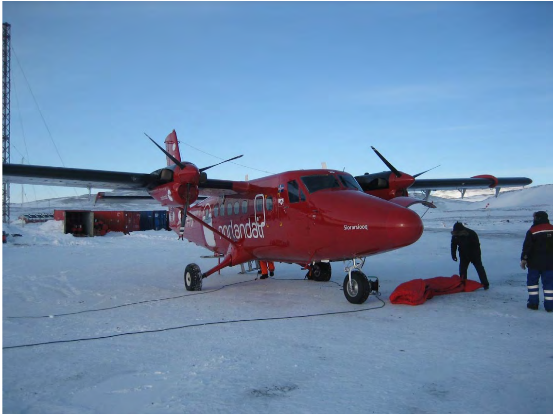
Twin Otter udstyret med LIDAR til indsamling af afstandsmålinger med høj præcision. Foto: René Forsberg
