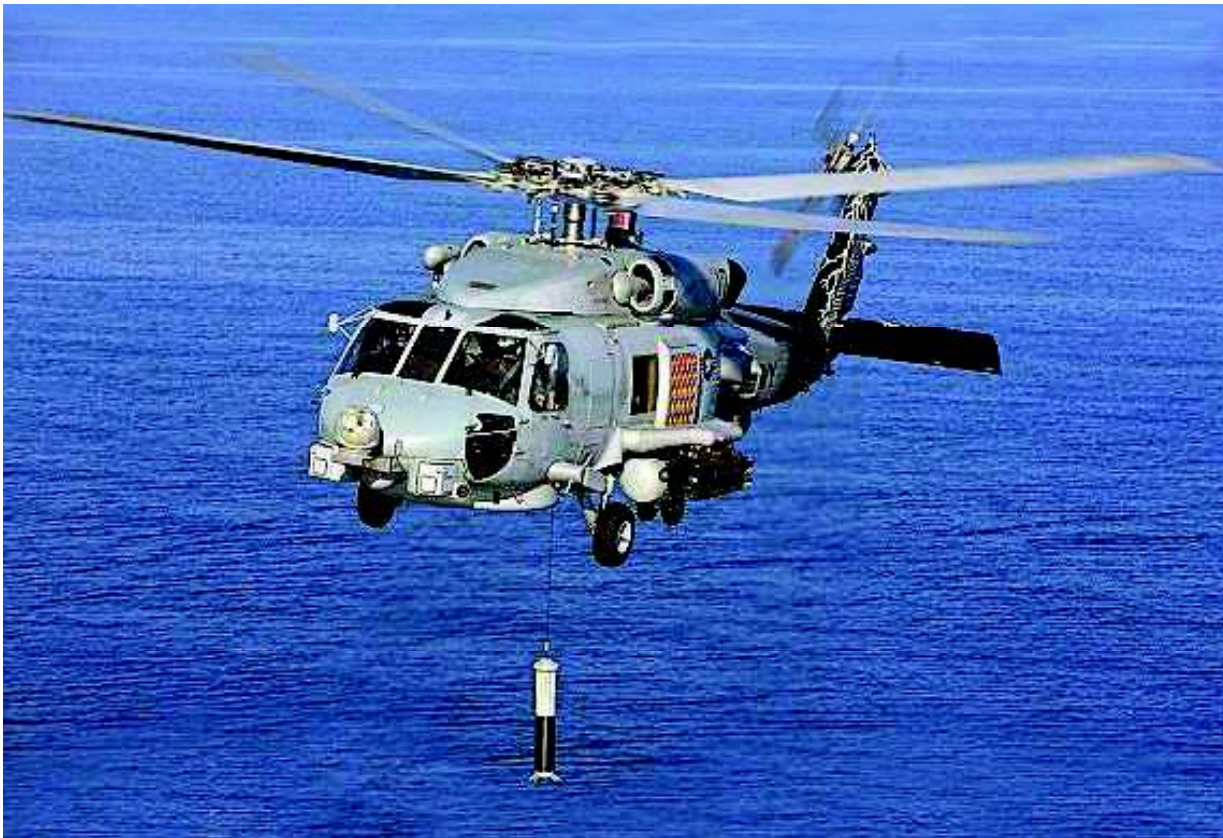
Amerikansk SEAHOAWK-helikopter med dyppesonar til anti-ubådsoperationer.
