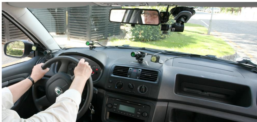
Figur 2.1: De tre kameraers placering på instrumentbrættet; til højre, til venstre og midt for testbilisten. Scenekameraet ses bag bakspejlet. Foto: Kasper Erling, Skoda.
