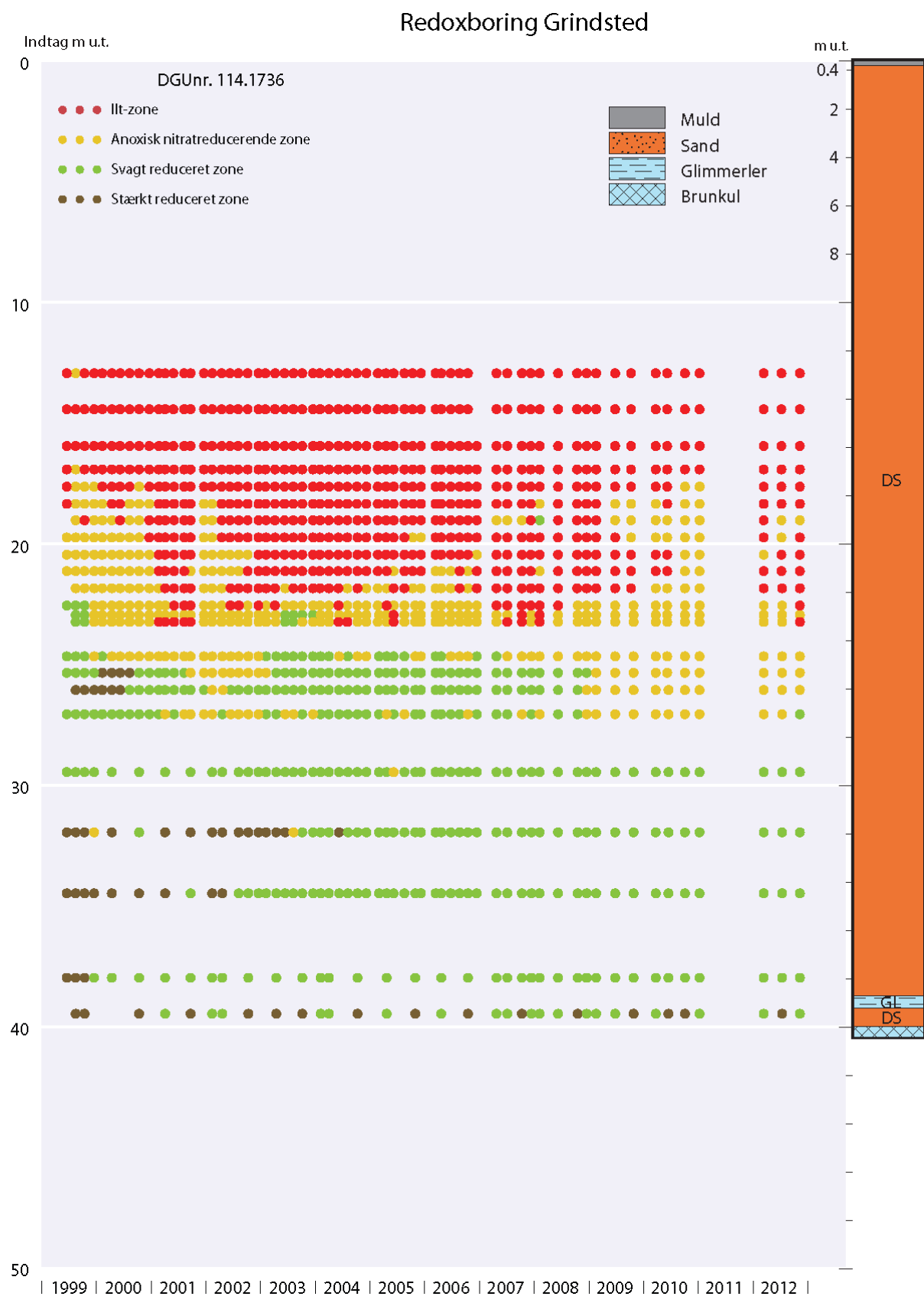
Figur 18. Redoxzoner 23- 40 m u.t. for redoxboring DGU nr. 114.1736, Grindsted 2000-2012. Grundvandspejl i ca. 6 m u.t. Den geologiske lagserie er vist på figuren længst til højre.
