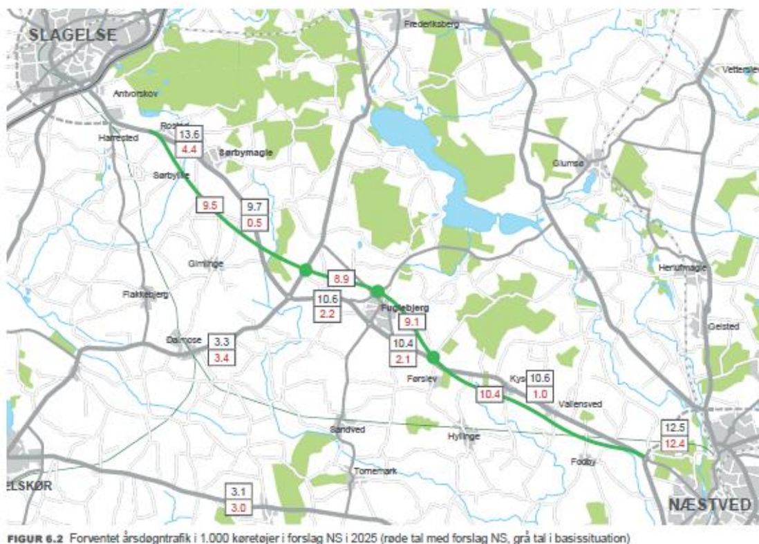
Figur 3 Årsdøgntrafik for de forskellige delstrækninger mellem Slagelse og Næstved. Kilde: Vejdirektoratets forundersøgelse Rute 22.
