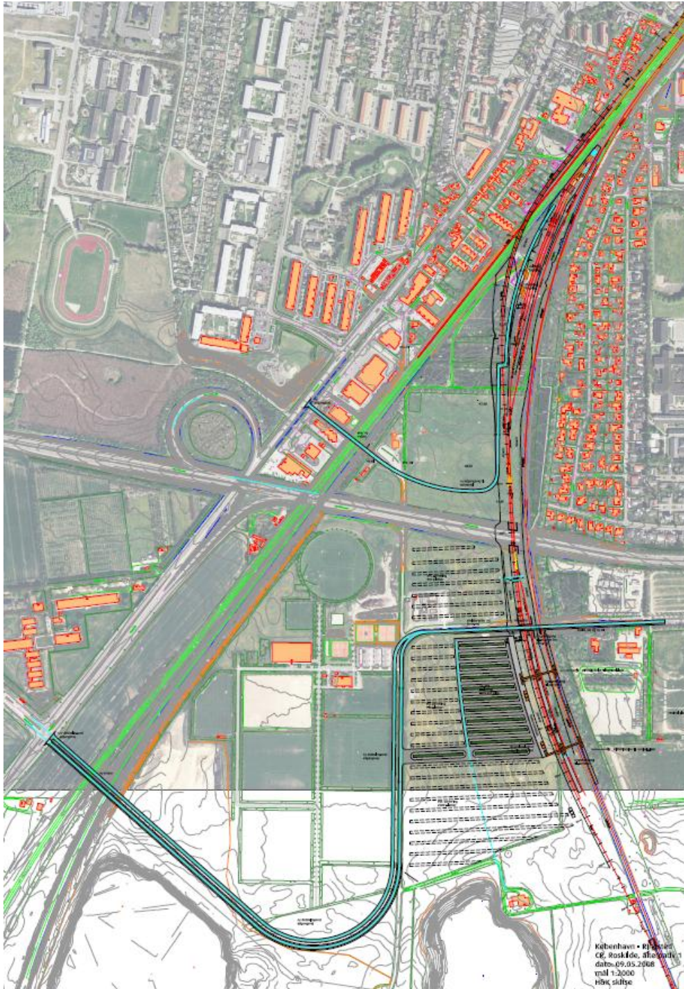
Figur 19. Skitseforslag af vendesporsanlæg i Roskilde. Skitsen viser alternativet, med forslag til placering af perroner, parkeringsanlæg, bygninger og vejadgang syd for Holbækmotorvejen.
