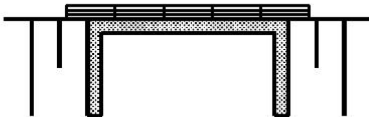
Figur 2. Principtegning for rammekonstruktion med lige sider. Rammekonstruktion
