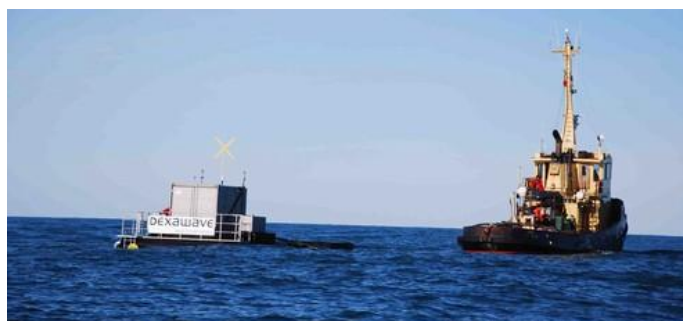
Figur 12 Dexawave bugseres til DanWEC placering (foto Dexawave).
