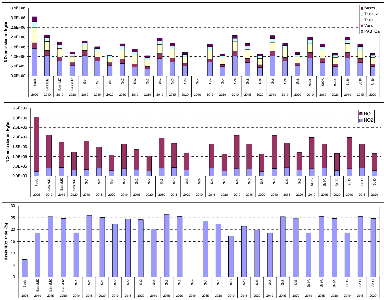
Figur 6.3 Øverst: Total emission underopdelte på køretøjskategorier for de forskellige scenarier. Midterst: Total NOx emission underopdelte i NO emission og direkte NO 2 emission. Nederst: Direkte NO 2 andel. Scenarie 7 vedr. overflytning kan ikke beregnes, da dette kun er behandlet som eksempelberegninger. Scenarie 4 om fremskyndelse af euronormer starter først i 2015. Alt data refererer til miljøzonen.
